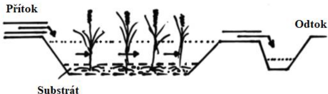
Obrázek 9: Schéma umělého mokřadu s vynořenou (emerzní) vegetací (Cooper a kol., 1996, upraveno).
