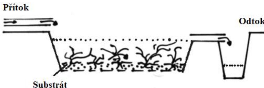
Obrázek 7: Schéma umělého mokřadu se submerzní vegetací (Cooper a kol., 1996, upraveno).
