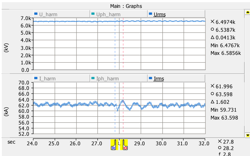
Obr. 6-14 Naměřené RMS hodnoty proudu a napětí
