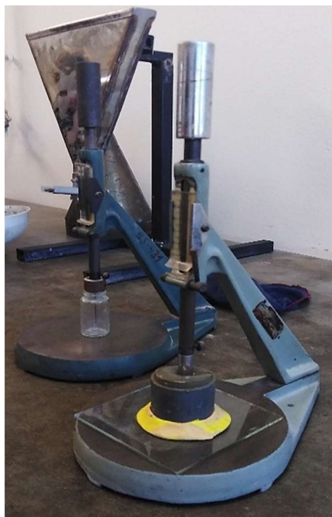
Obrázok 10: Vicatove prístroje s hustomerovým valčekom a ihlou.
