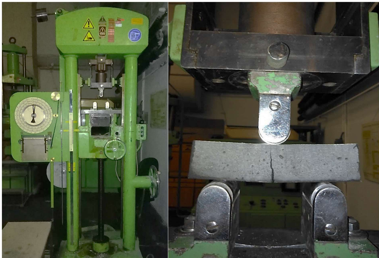
Obrázok 16: Skúšobný lis (vľavo) a detailný záber zaťažovacích valcov (vpravo).
