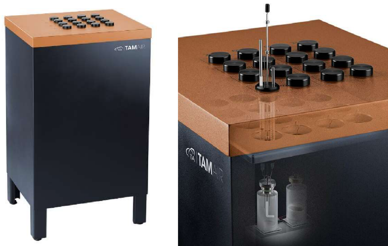
Obrázok 11: Izotermálny kalorimeter TA Instruments, TAM Air [57].
