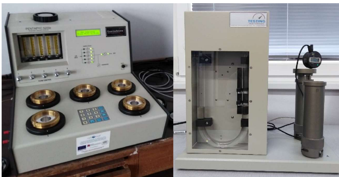
Obrázok 5: Pycnometer Quantachrome Pentapyc 5200e (vľavo), Blainov prístroj (vpravo).
