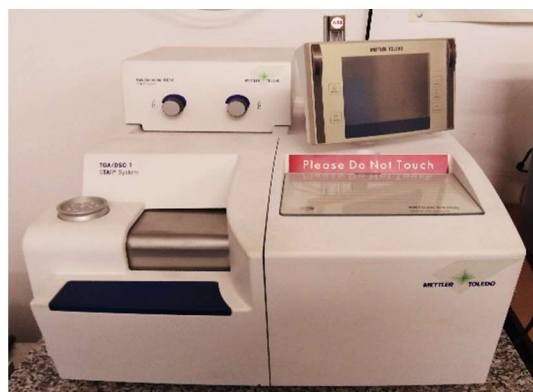
Obrázok 20: Termický analyzátor Mettler Toledo, TGA/DSC – 1.
