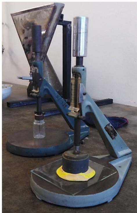
Obrázok 10: Vicatove prístroje s hustomerovým valčekom a ihlou.
