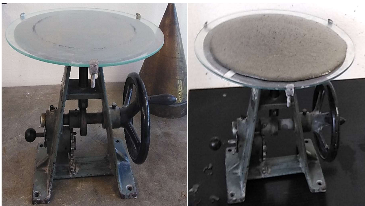
Obrázok 12: Podkladová doska s kužeľovou formou (vľavo) a podkladová doska s maltovou zmesou po ukončení skúšky (vpravo).
