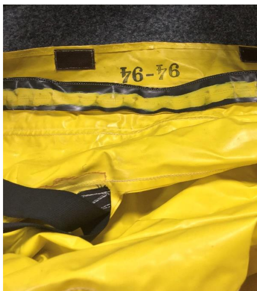
Obrázek 6. Fotografie podélného plynotěsného zdrhovadla s našitou chlopní Vytištěné číslo na chlopní značí rok výroby daného obleku.
