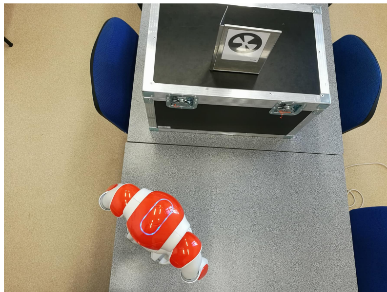
Obrázek 3.7: Centrování robota do osy, využívající údaje o vzdálenosti ze sonarů
