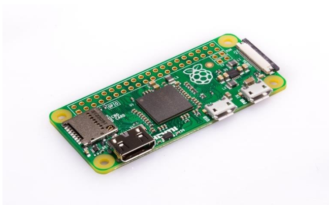
Obrázek 7 - Raspberry Pi Zero [14]
