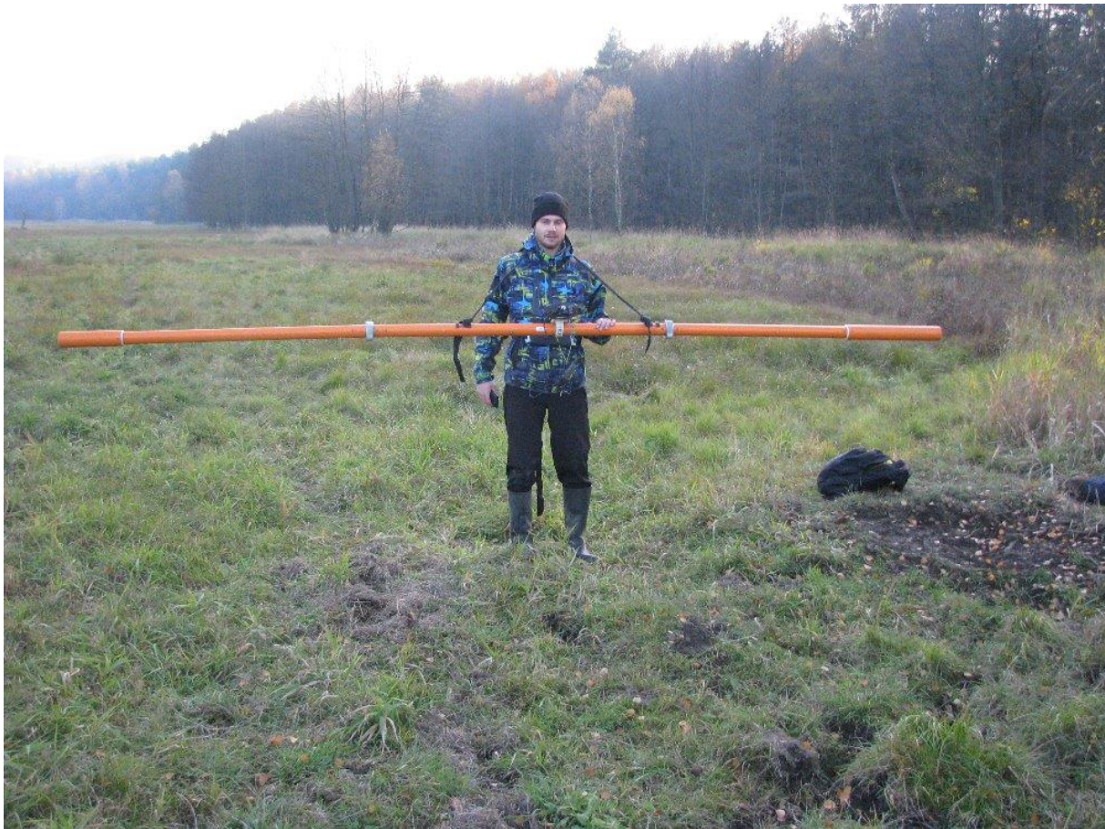
Obr. 11. Konduktometr CMD-4 při práci v terénu na lokalitě Sádlo. Foto: Martin Faměra.
