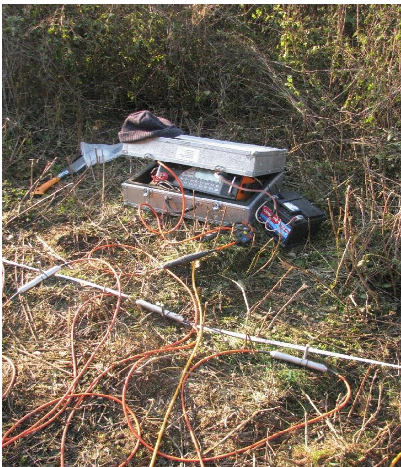
Obr.10. Řídicí jednotka ARES při měření na lokalitě Boreček. (Foto: Michal Šulc).
