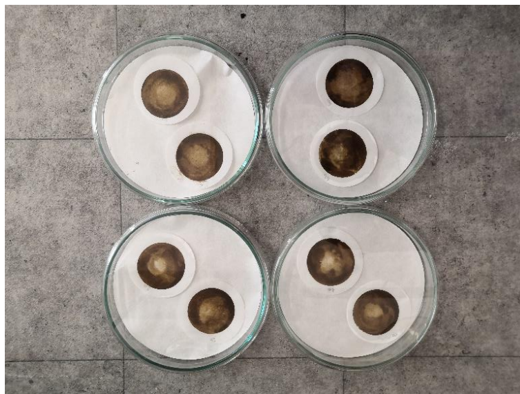
Obrázok 9 Filtre so zachytenými nerozpustnými látkami
