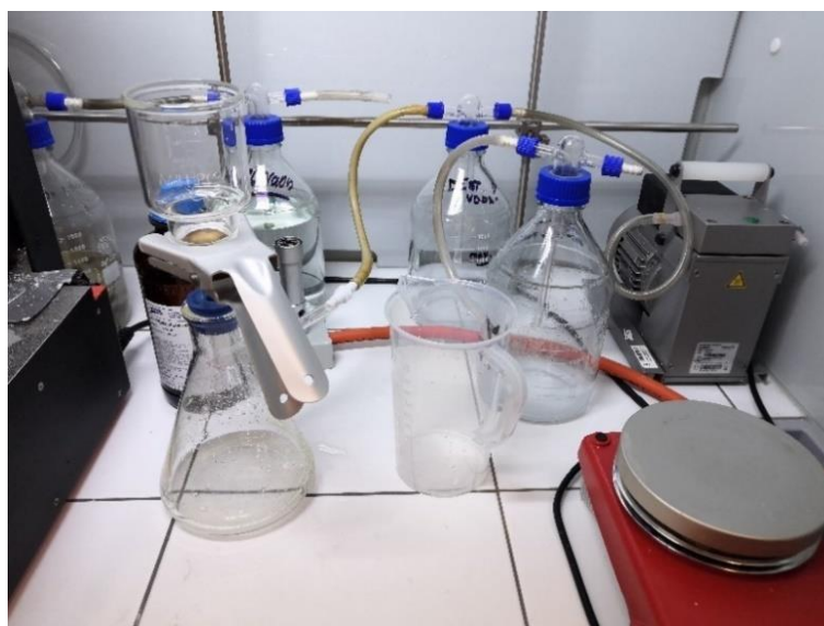
Obrázok 10 Mechanizmus filtrovania nerozpustných látok
