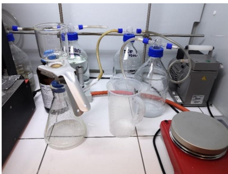
Obrázok 10 Mechanizmus filtrovania nerozpustných látok
