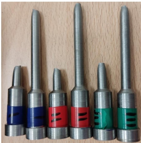
Obrázek 36: Přetržené ocelové vzorky
