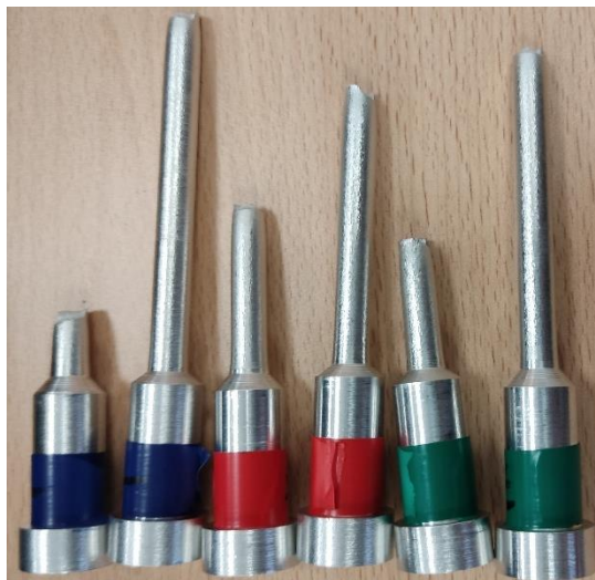
Obrázek 38: Přetržené hliníkové vzorky
