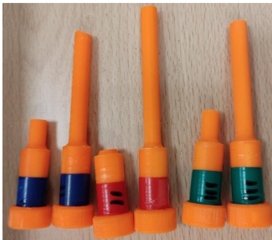
Obrázek 40: Přetržené ABS plastové vzorky
