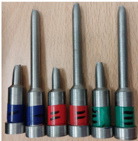
Obrázek 36: Přetržené ocelové vzorky
