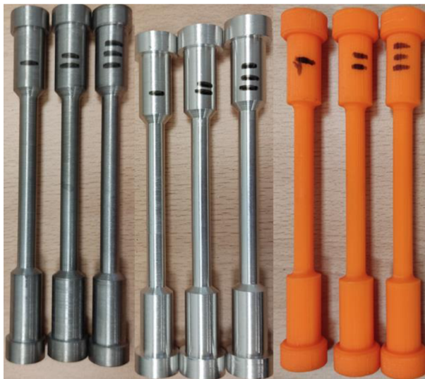
Obrázek 34: Hotová zkušební tělesa (zleva: ocel, hliník, ABS plast)
