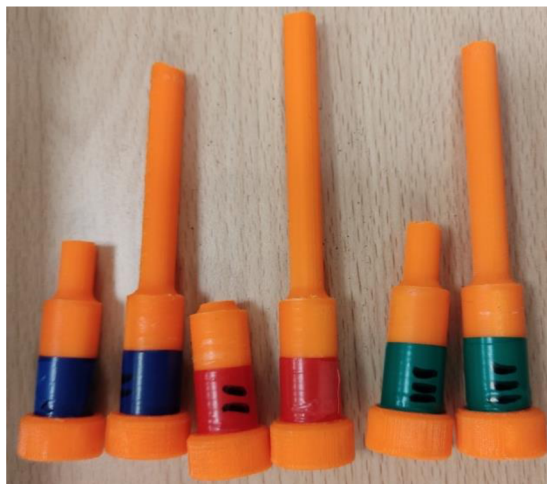
Obrázek 40: Přetržené ABS plastové vzorky
