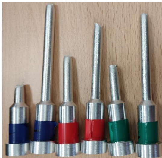
Obrázek 38: Přetržené hliníkové vzorky
