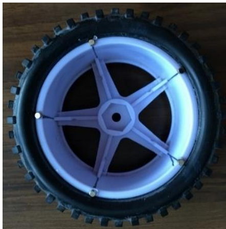
Obr. 16 Ráfek kola s neodymovými magnety
