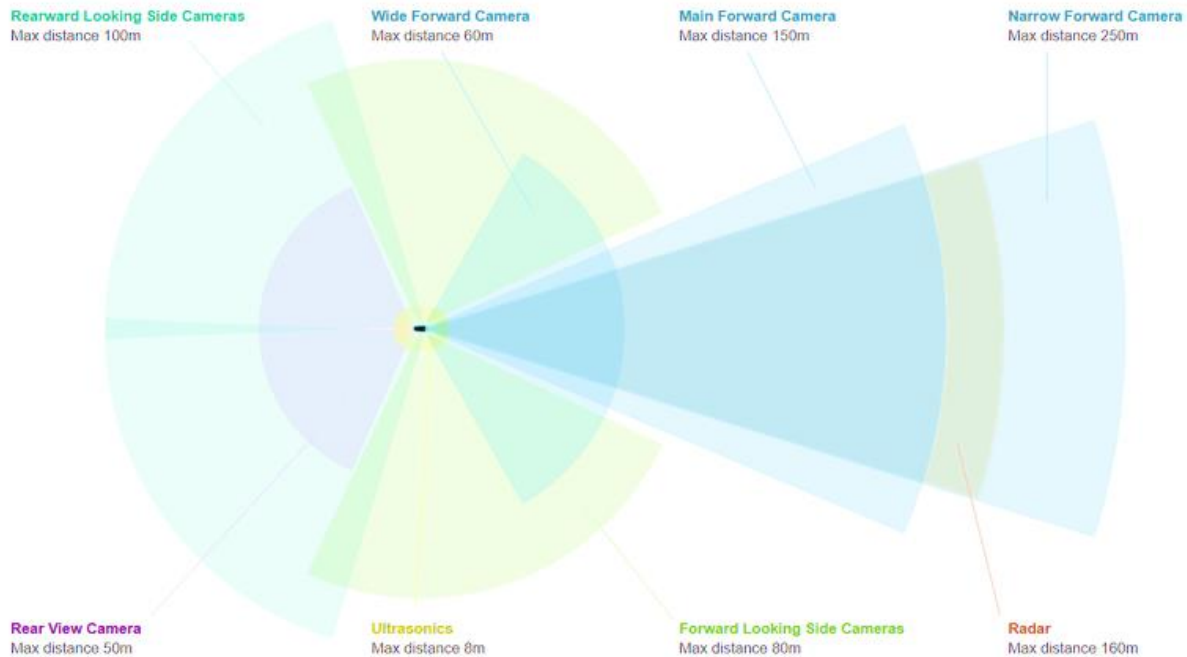
Obr. 8 Spolupráce všech senzorů Tesla Model S [16]
