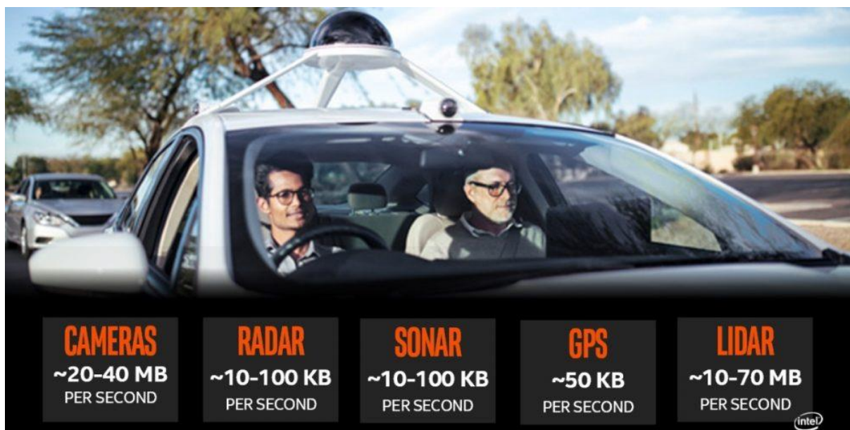
Obr. 5 Tok Dat ze senzorů autonomních vozidel [12]
