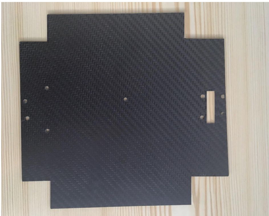
Obr. 25 Karbonová platforma senzorů
