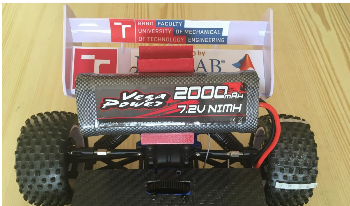
Obr. 26 Držák baterie umístěný na vozidle
