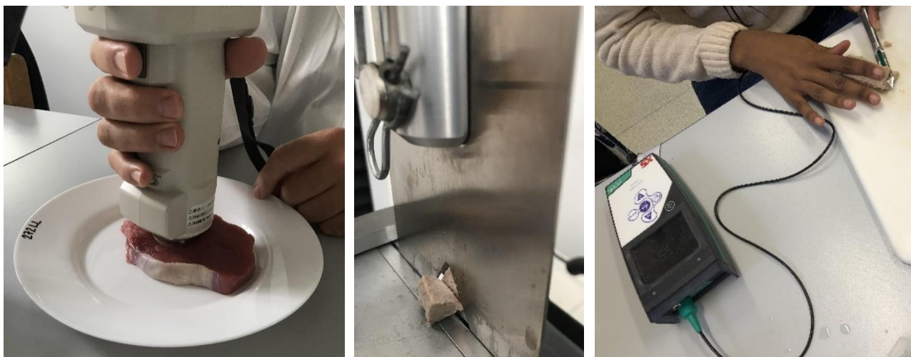
Obr. 7-9 – Měření fyzikálních vlastností masa (zleva: barvy pomocí spektrofotometru, tuhosti pomocí WB nože a přístroje Instron a pH pomocí pH metru) (foto autorka DP).
