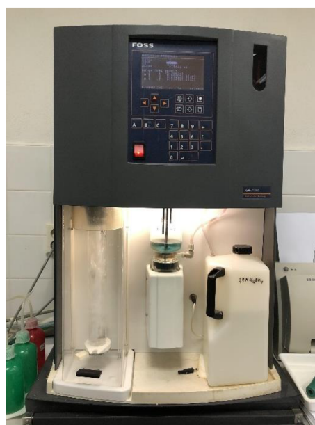
Obr. 14 – Stanovení obsahu bílkovin pomocí Kjeltec 2400 (foto autorka DP).
