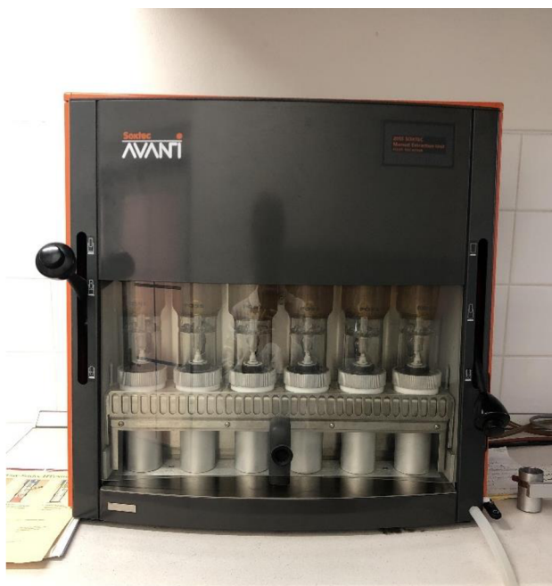
Obr. 15 – Stanovení obsahu intramuskulárního tuku pomocí Soxhlet Avanti 2055 + Obr. 16 – důkaz velmi nízkého obsahu tuku u antilopy losí (foto autorka DP).
