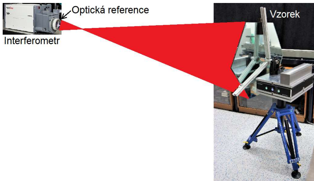
Obr. 75: Schéma měření konkávní sférické plochy hexagonálního skleněného zrcadla pomocí interferometru. Interferometr s optickou referencí i vzorek jsou umístěny na aktivních antivibračních stolech. Mezi interferometrem a vzorkem je červeně vyznačen tvar měřicího svazku.
