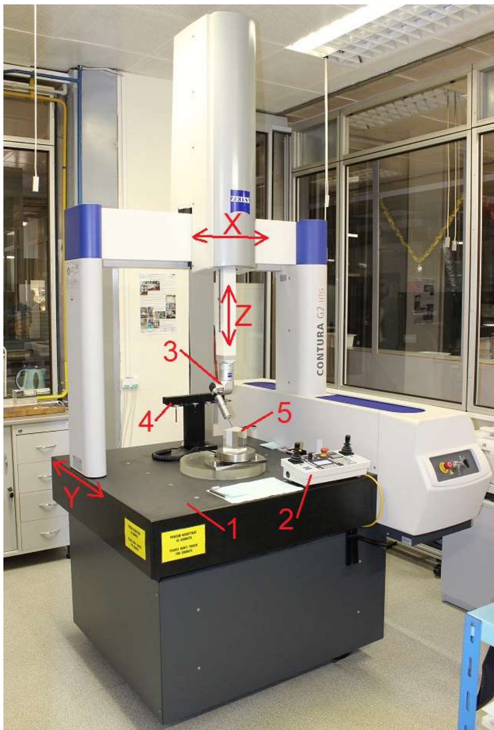
Obr. 19: Třísouřadnicové měřidlo Zeiss Contura G2 HTG. 1 – granitový stůl, 2 – manuální ovládání všech os, 3 – výměnná měřicí hlava se sondou, 4 – držák sond pro jejich automatickou výměnu, 5 – měřený vzorek. x , y , z – vyznačené osy zařízení.
