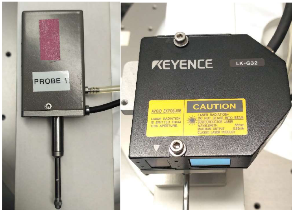
Obr. 27: Vlevo – kontaktní sonda Solartron LE LT 12P, vpravo – bezkontaktní triangulační sonda Keyence LK-G32.
