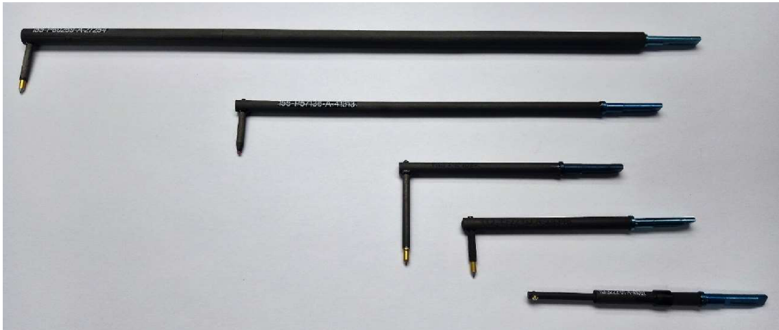
Obr. 16: Ukázka několika typů měřicích ramének kontaktního profilometru Taylor Hobson.
