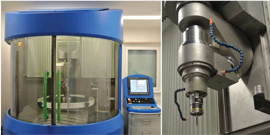
Obr. 20: Zařízení Zeeko IRP – 800G, vlevo celkový pohled na zařízení, vpravo detail nástrojové hlavy osazené měřicí sondou [57].
