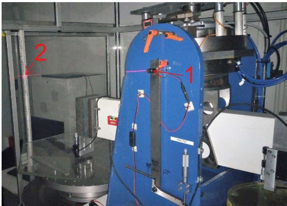
Obr. 53: Laserový modul pro určení sklonu hlavního vzduchového ložiska. 1 – laserový modul namontovaný přímo v ose sklonu hlavního ložiska, 2 – stopa lineárního svazku laseru na svislém pravítku.
