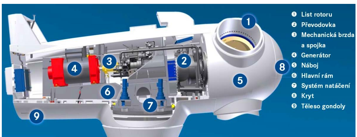
Obr. 42 Uspořádání strojovny větrné elektrárny Wikov W2000 [7]
