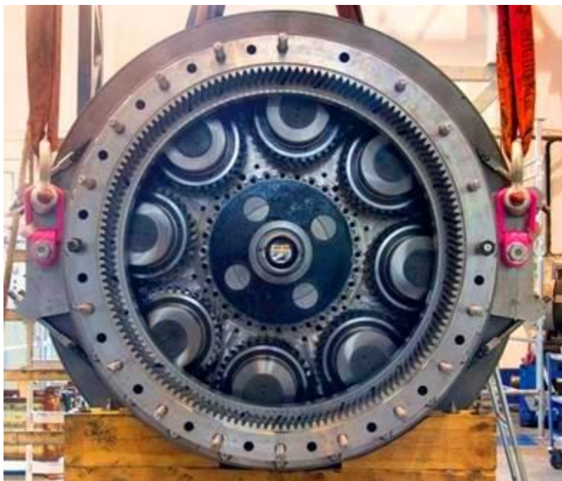
Obr. 44 Detail převodovky Wikov. Planetový stupeň s osmi satelity uloženými na pružných čepch [7]
