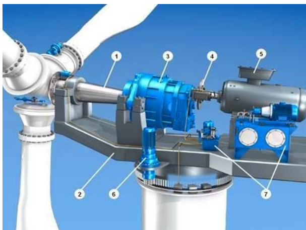
Obr. 38 Schéma strojovny větrné elektrárny firmy Siemens [7]
