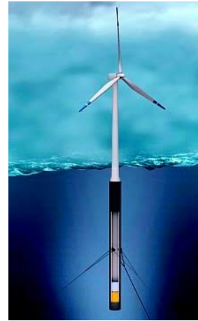
Obr. 19 Schéma ukotvení plovoucích větr. elektráren [15]
