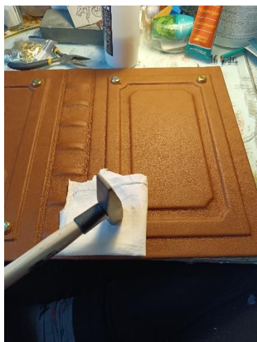
Obr. 116 a 117: Aplikácia kovových komponentov na knižné dosky
