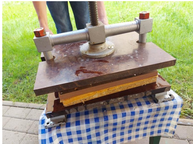
Obr. 62: Odvodnenie papiera v lise
