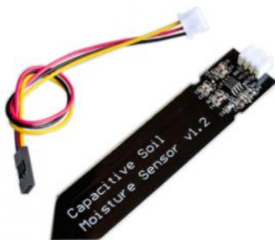
Obrázek 14 Kapacitní sensor vlhkosti půdy [36]
