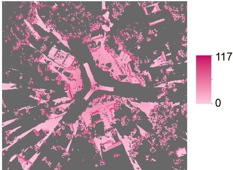
Obr. 28: Hodnoty indexu rozdílu sklonu LoS a pohledového úhlu.
