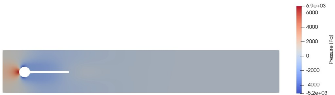
Obrázek 9: tlak tekutiny obtékající těleso v čase 9 sekund
