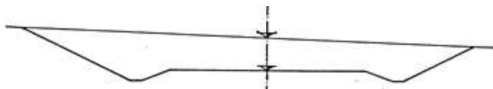
Obrázek č. 8 Základní tvar zemního tělesa v zářezu (URL 8)
