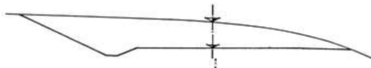
Obrázek č. 10 Základní tvar zemního tělesa v odřezu (URL 10)
