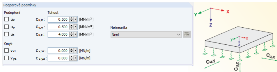
Obrázek 3-2: Uložení základové desky
