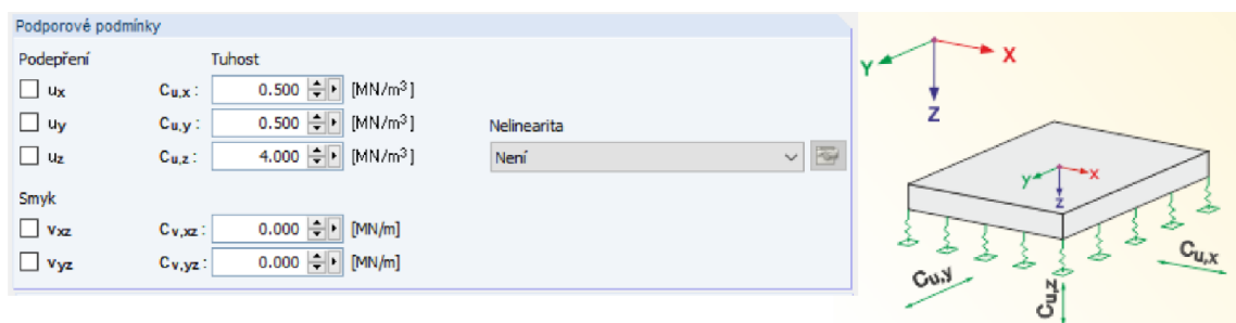
Obrázek 3-2: Uložení základové desky
