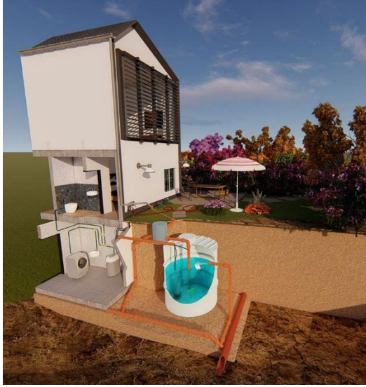
Obr. 7: Příklad dešťové retenční nádrže (Hydroplast, 2020)
