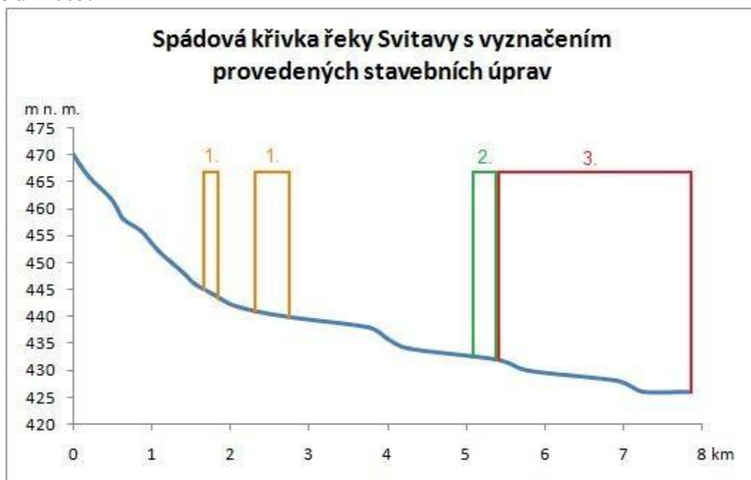
Graf 12: Spádová křivka řeky Svitavy s vyznačením provedených stavebních úprav z let 1998 až 2005.
