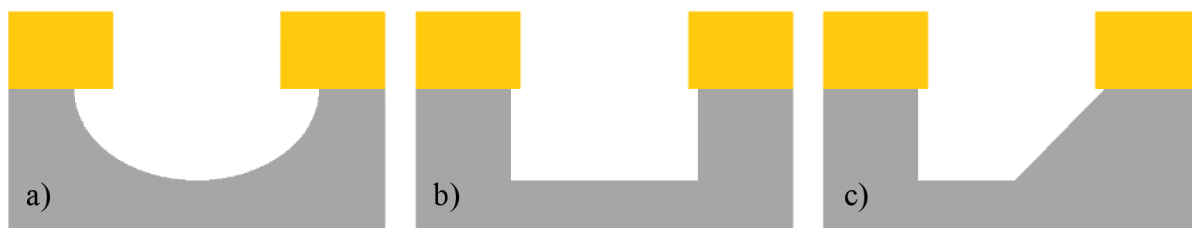
Obrázek 6.5: Výsledek selektivního a) izotropního a b), c) anizotropního leptání; část c) znázorňuje případ krystalického materiálu.
