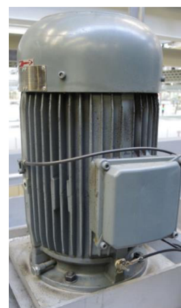
Obrázek 24: Motor pro míchání atmosféry.
