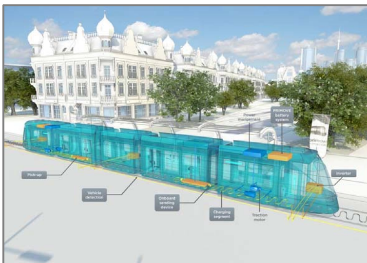
Obr. 2-25 Schéma indukčního napájení Primove [33]
