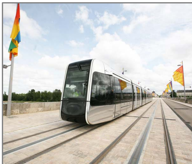
Obr. 2-24 Alstom Citadis 420 Tours, třetí kolej [32]
