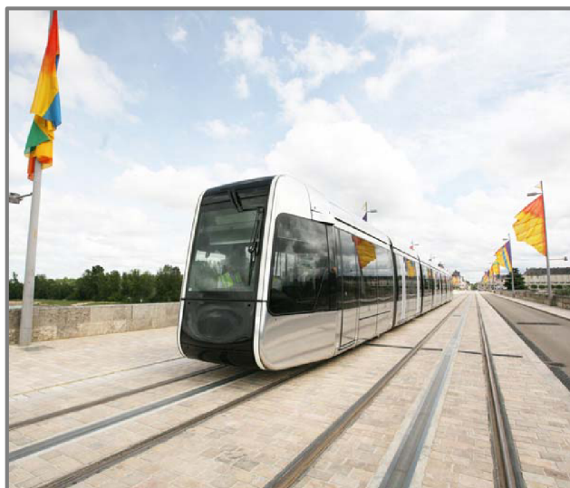
Obr. 2-24 Alstom Citadis 420 Tours, třetí kolej [32]
