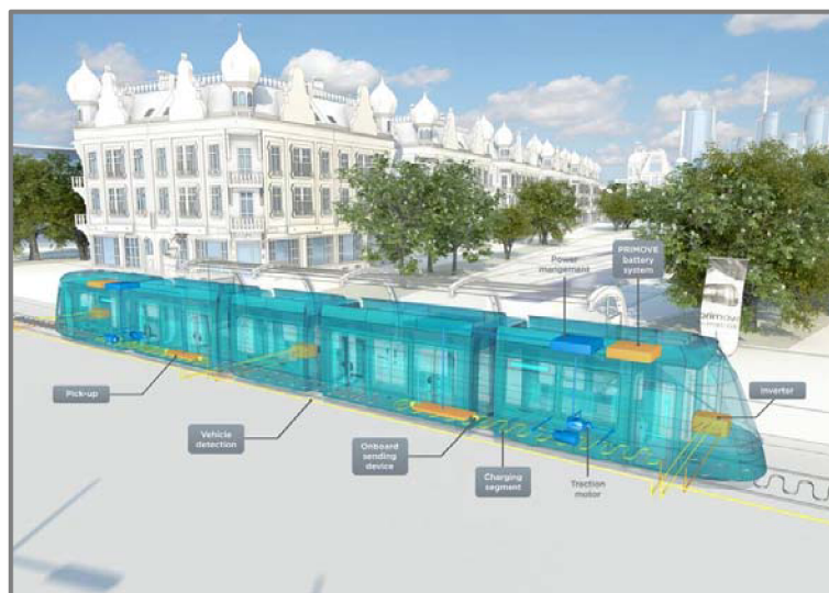
Obr. 2-25 Schéma indukčního napájení Primove [33]
