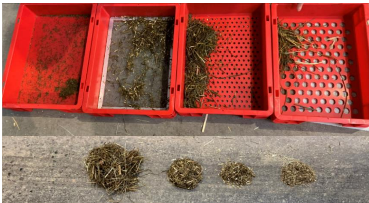
Obrázek 1. Penn State Partical Separator se sítí 19, 8 a 4 mm, včetně materiálu po protřepání (Lely 2022)
