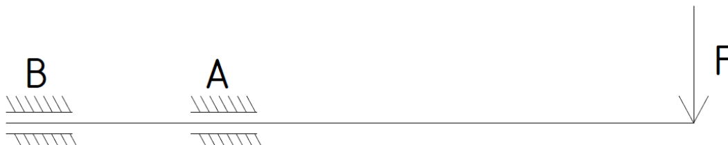
Obrázek 52: Znáznornění uložení smykadla
