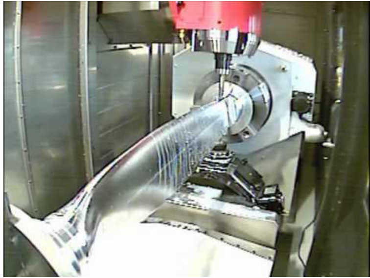
Obrázek 19: 4 osé obrábění vrtule [3]
