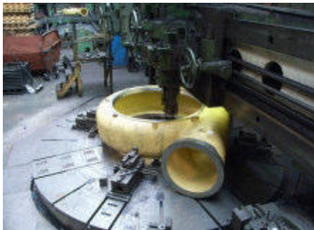
Obrázek 4: Upnutí nerotačního obrobku na soustružnickém stole [3]
