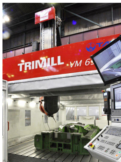
Obrázek 45: Smykadlo stroje TriMill VM 6535 [7]
