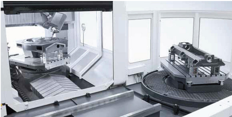
Obrázek 20: Systém výměny palet na portálovém stroji DMG [11]
