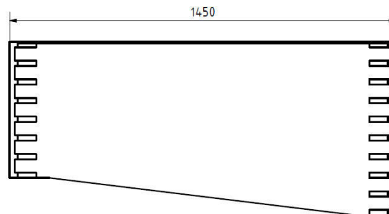
Obrázek 76: Základní profil odlitku sloupu
