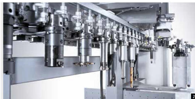
Obrázek 24: Standardní řetězový zásobník nástrojů u stroje DMG [11]
