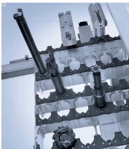
Obrázek 26: Policový zásobník DMC Portal firmy DMG [11]
