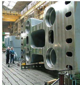
Obrázek 5: Upnutí těžkého obrobku [3]
