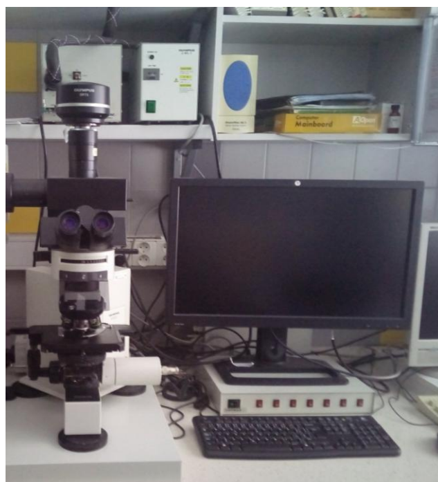
Příloha č. 4: Světelný mikroskop Olympus BX50 s kamerou Olympus DP72 a PC (foto: autor práce).
