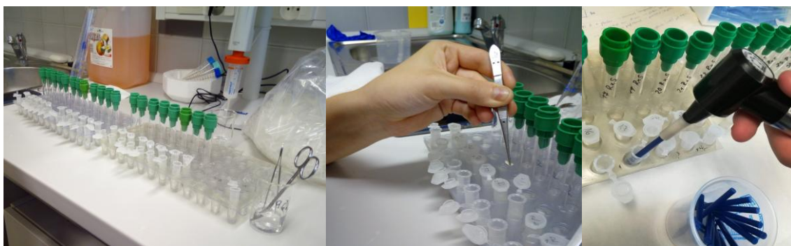
Příloha č. 2: Příprava vzorků k měření relativního obsahu DNA pro průtokovou cytometrii – připravené „ependorfky“ a kyvety s 30 \mu\text{m} nylonovými filtry pro zpracování odebrané tkáně (vlevo); odběr reprezentačního vzorku ( 1\text{mm}^2 ) z odebraného vzorku (uprostřed); a homogenizace reprezentačního vzorku (vpravo) (foto: autor práce, Marie Raušová).
