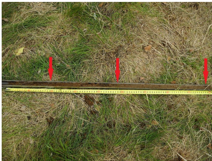
Obrázek 4: Horizontování půd v terénu pomocí sondýrky (zdroj: Ing. Anna Francová)
