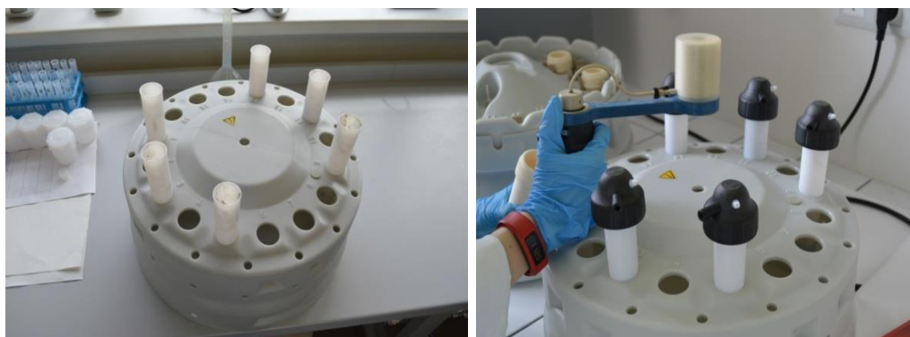
Obrázek 7: Teflonové patrony a příprava vzorků před mikrovlnným rozkladem (zdroj: Lucie Johanisová, 2017)
