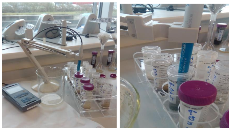
Obrázek 6: Stanovení pH digitálním pH metrem
