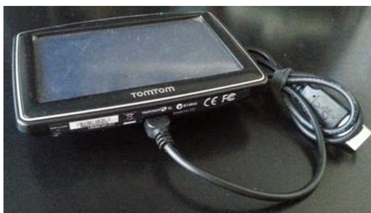
Obr. 46 – TomTom – umístění napájecího kabelu
