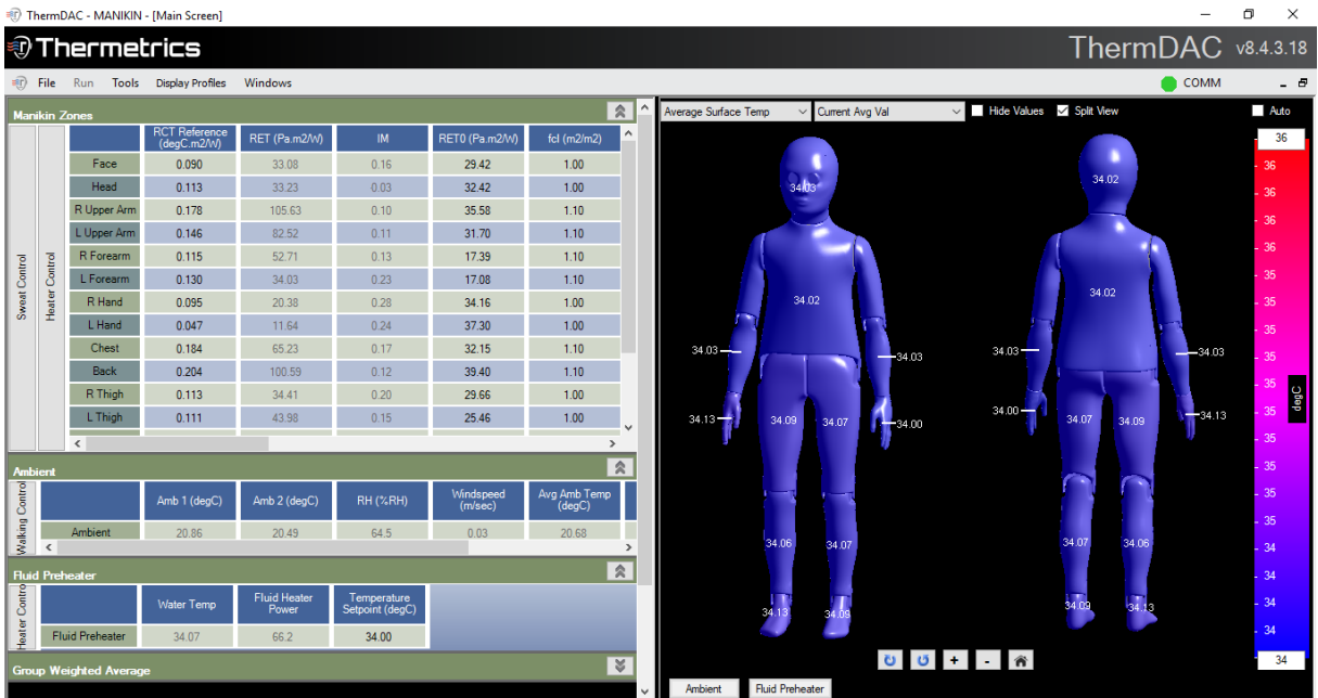
Obr. 20.: Ukázka pracovního prostředí softwaru pro ovládání tepelného manekýna – výparný odpor
