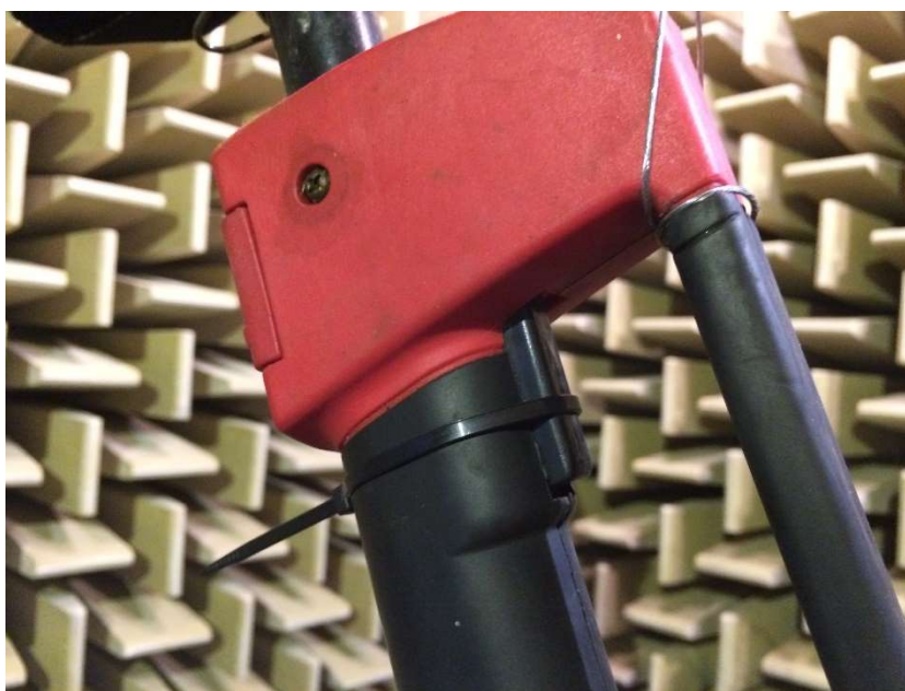
Obr. 18 Způsob zajištění spouštěcího tlačítka
