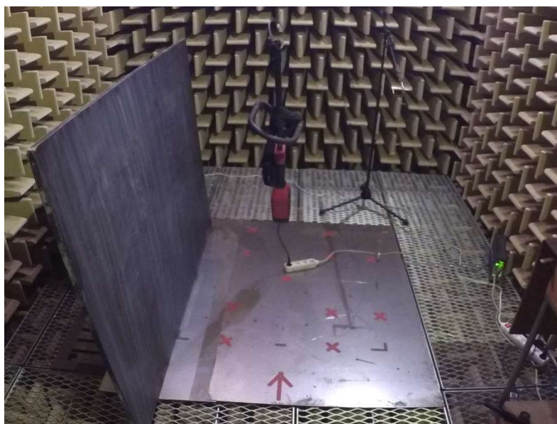
Obr. 22 Měření 2 s odrazivou spodní a levou stranou
