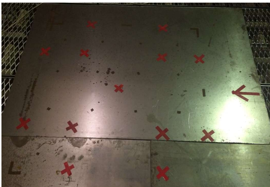
Obr. 19 Spodní strana měřicí plochy s vyznačenými pozicemi měřicích bodů
