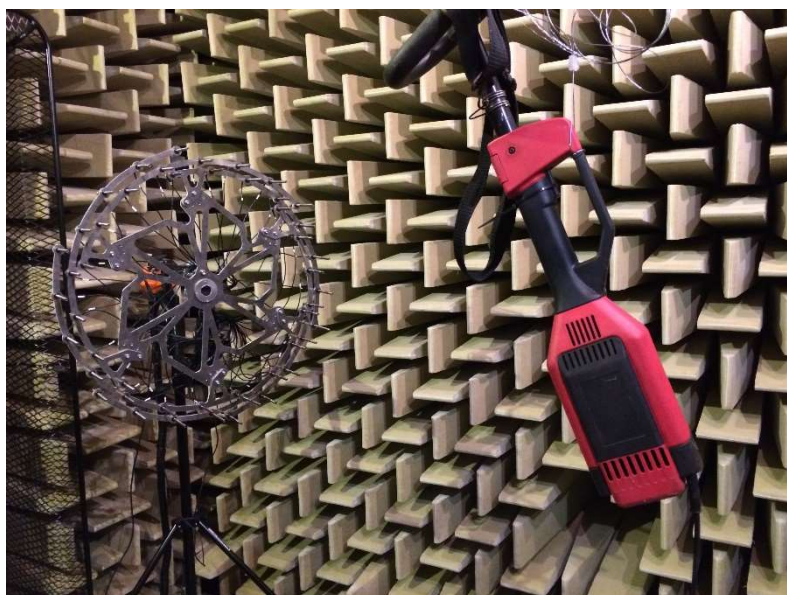
Obr. 32 Lokalizace zdroje hluku pomocí akustické kamery
