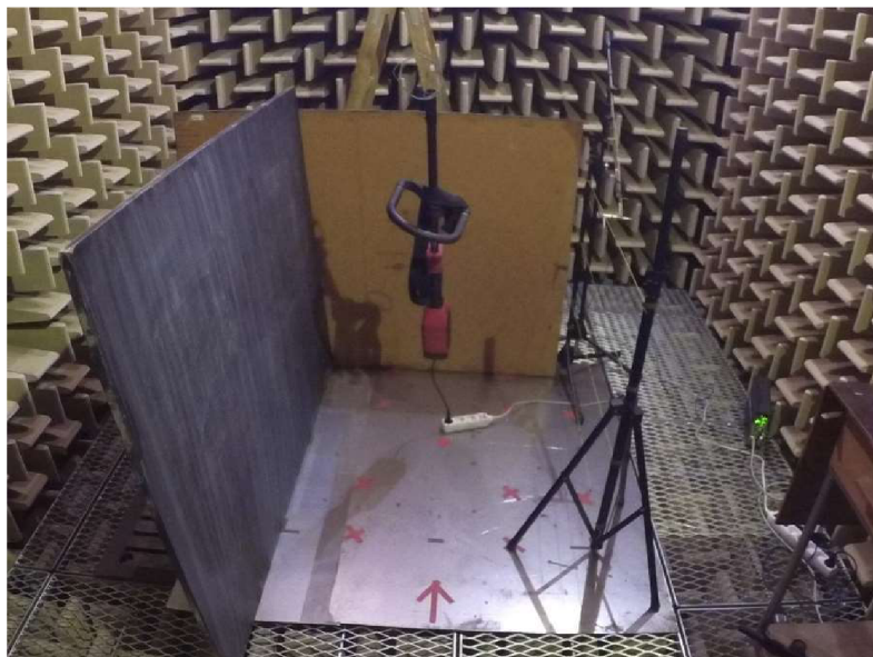
Obr. 24 Měření 3 s odrazivou spodní, levou a zadní stranou
