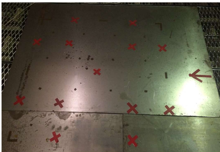
Obr. 19 Spodní strana měřicí plochy s vyznačenými pozicemi měřících bodů
