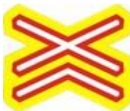
Obr. 15: Zvýrazněné označení výstražného kříže pro vícekolejný přejezd
