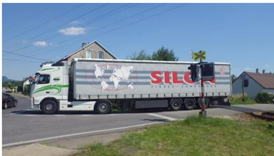
Obr. 5: Nedostatečná vzdálenost přejezdu od hranice křižovatky
