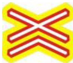
Obr. 15: Zvýrazněné označení výstražného kříže pro vícekolejný přejezd
