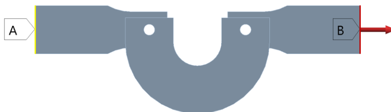
Obrázek 68: Okrajové podmínky modelu prutu 1 s přípravky
