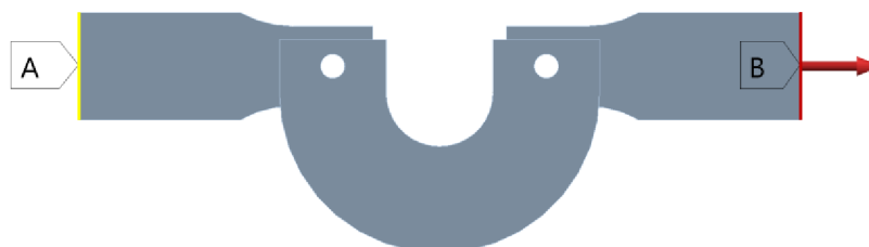
Obrázek 68: Okrajové podmínky modelu prutu 1 s přípravky
