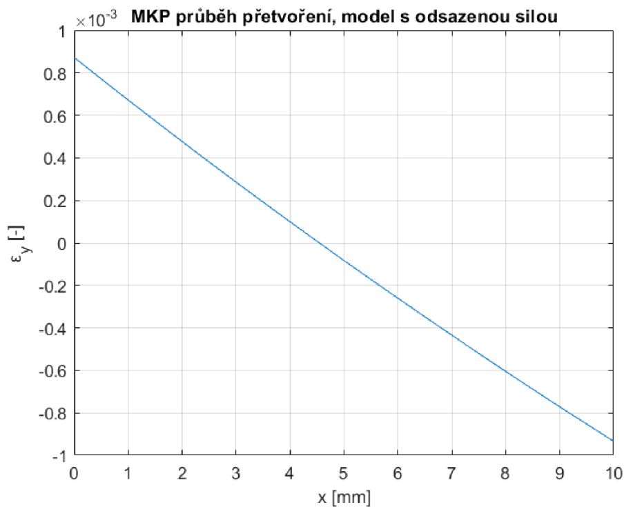
Obrázek 74: Průběh přetvoření na povrchu modelu prutu 2 na ose symetrie, model s odsazenou silou
