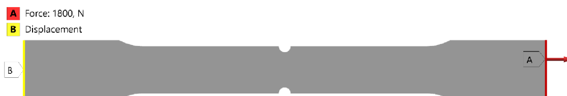
Obrázek 33: Okrajové podmínky modelu vzorku 1
