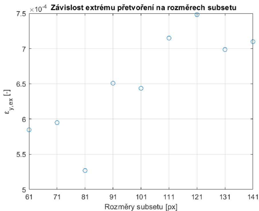
Obrázek 29: Extrémní hodnota přetvoření ve vrubu v závislosti na velikosti subsetu pro délku příčných čar 1 mm
