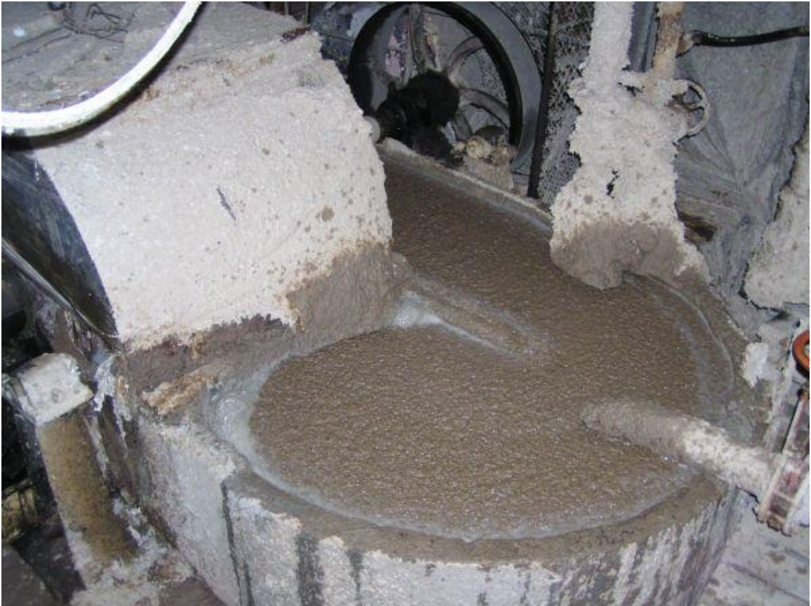
Obr. 16 Počátek výroby – rozmělnění surovin ve stroji zvaném holendr
