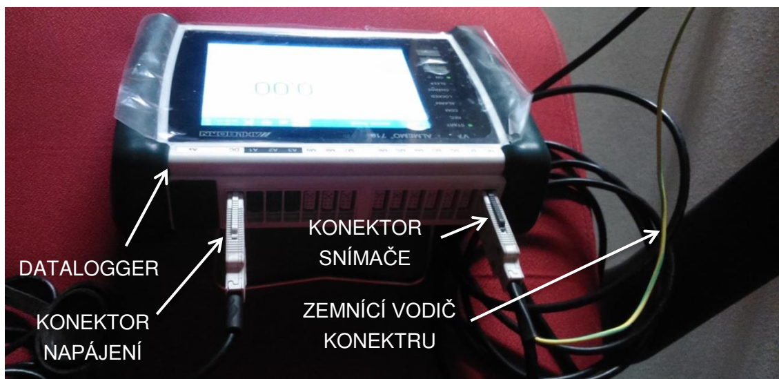
Obr. 28: Zapojení dataloggeru (AB)
