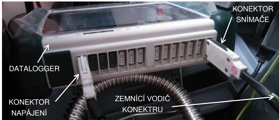
Obr. 31: Zapojení dataloggeru (VaVC)
