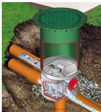
Obr. 3: Podzemní šachtový filtr [3]
