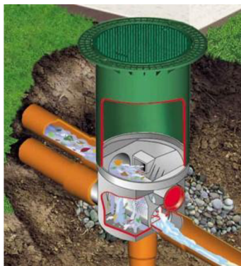
Obr. 3: Podzemní šachtový filtr [3]
