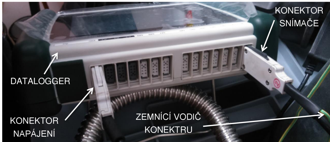
Obr. 31: Zapojení dataloggeru (VaVC)
