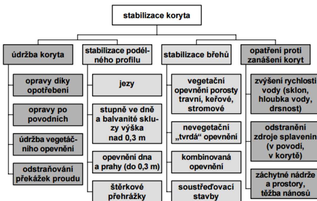
Obr. č. 7: Způsoby stabilizace koryta. Zdroj: Jílková et al. 2006
