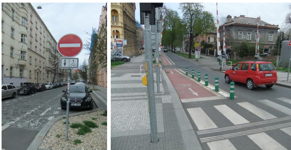
Obr. č. 23. Cykloobousměrky v ulici Dr. Zikmunda Vintera a Pelléova. Zdroj: vlastní
