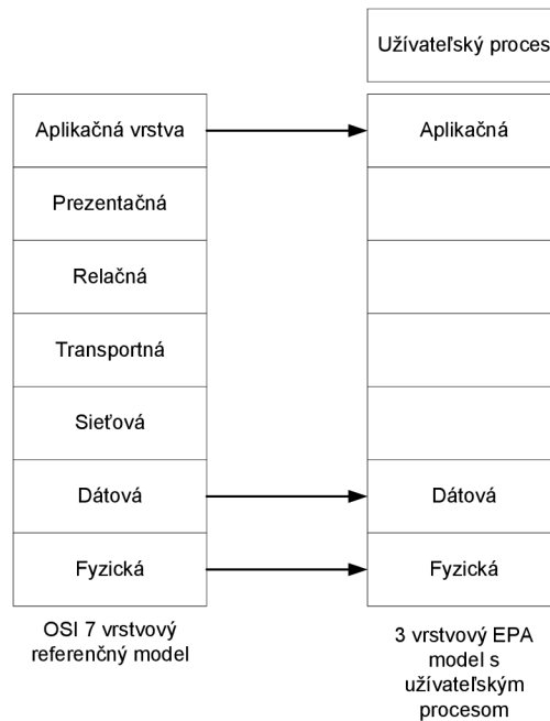
Obr. 2.10: Porovnanie referenčného OSI modelu s 3 vrstvovým EPA modelom
