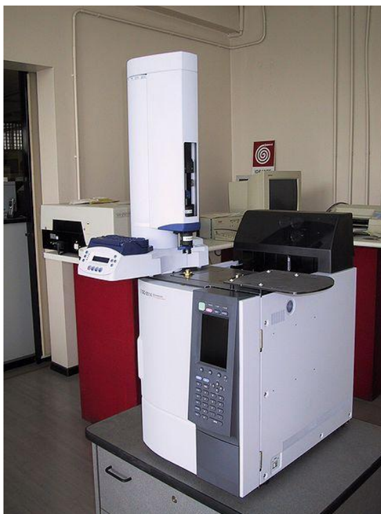
Obr. 10: Plynový chromatograf Hewlett Packard. Model 5890 46
