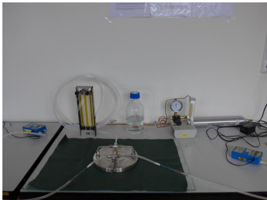
Obr. 9: Emisní cela FLEC® při odběru vzorku vzduchu z testovaného materiálu
